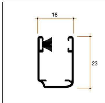
Rilevazione della **misura foro/luce** per l'installazione nel fermavetro
