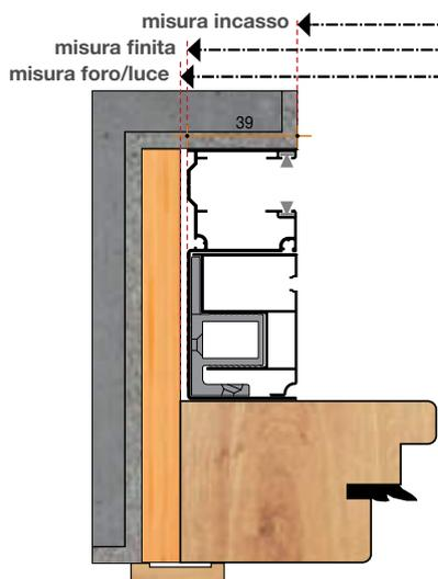
Esempio di installazione Guida Tapparella da 90 mm
