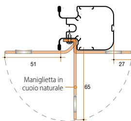
Maniglietta flessibile in cuoio naturale, realizzata a mano, che permette di estrarre la barra maniglia quando l'impugnatura di essa non è accessibile perché coperta dal serramento o da altro impedimento. Grazie a questo accessorio si può prevedere **l'incasso totale della barra maniglia.**
