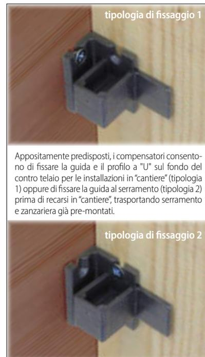
Appositamente predisposti, i compensatori consentono di fissare la guida e il profilo a "U" sul fondo del contro telaio per le installazioni in "cantiere" (tipologia 1) oppure di fissare la guida al serramento (tipologia 2) prima di recarsi in "cantiere", trasportando serramento e zanzariera già pre-montati.
