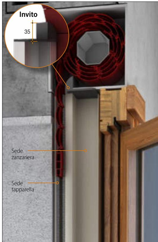
Al fine di integrare con facilità il sistema zanzariera con il sistema tapparella sono state create due guide specifiche dotate di una sezione, completa di spazzolini e di apposito invito per lo scorrimento della tapparella (profilo 14x55 mm) e una seconda sezione per l'inserimento dei sistemi zanzariera incasso da 50 mm. Un sistema integrato che arricchisce la casa con una finitura sicuramente di alto pregio.
