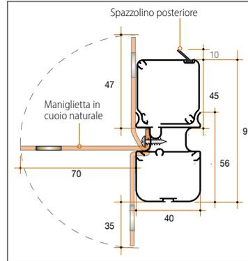
**Compensatore e guida montata.**
