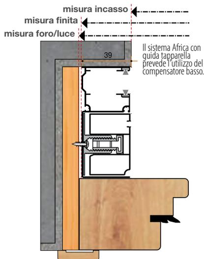
Esempio di installazione Guida Tapparella da 90 mm
