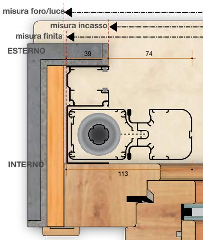
Esempio di installazione Guida Tapparella da 90 mm
